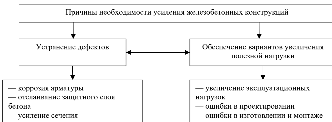
Рисунок 1. Проблемы, решаемые для усиления строительных конструкций углеродным волокном (составлено авторами по источникам информации [1–3])
