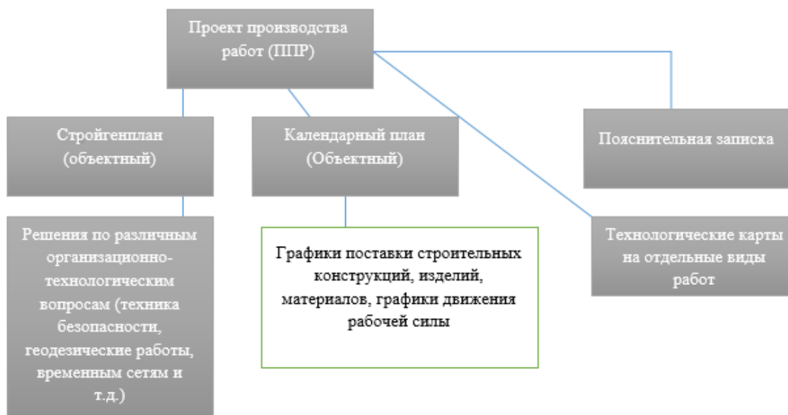
Рисунок 2. Проект производства работ (разработано автором)
