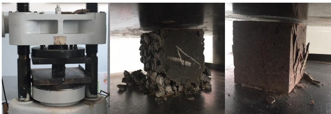
Рисунок 1. Испытание бетонных образцов на сжатие (разработано авторами)
