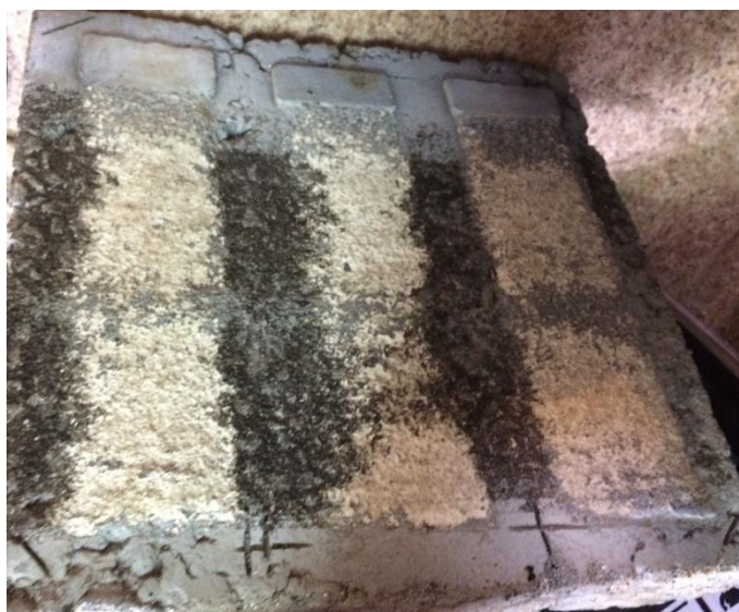
Рисунок 2. Результаты испытаний разметочного материала на основе полиуретана на универсальном комплексе для испытания дорожных покрытий и автомобильных шин «Карусель» (фото авторов)
