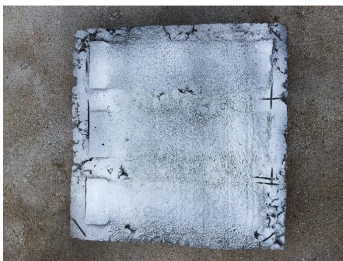
Рисунок 1. Стандартный образец 30x30 см, предназначенный для испытания на универсальном комплексе «Карусель-2» (фото авторов)
