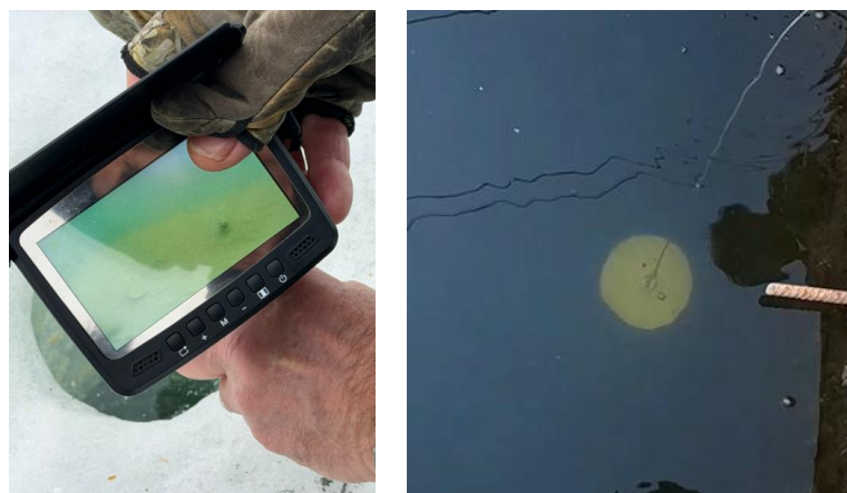
Рисунок 3. Подводные исследования с помощью подводной камеры и диска Секки (составлено авторами)
