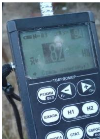
Рисунок 4. Результат выполненного измерения твердости стальной колонны (создано авторами)
