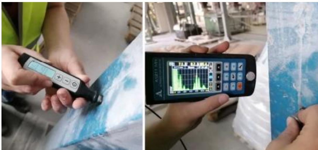
Рисунок 3. Контроль толщины швов ивеллера в составном сечении колонны (создано авторами)
