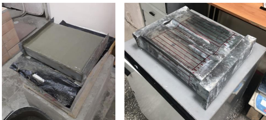
Рисунок 4. Подготовка цельного образца для испытания неразрушающим методом (выполнено авторами)
