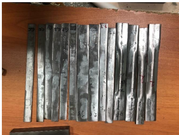
Рисунок 5. Образцы для испытания неразрушающим методом и процесс проведения эксперимента (выполнено авторами)
