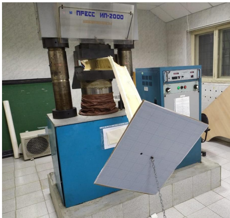
Рисунок 10. Балка со сплошной стенкой и длиной консоли 1.5 м после испытания (фото авторов)
