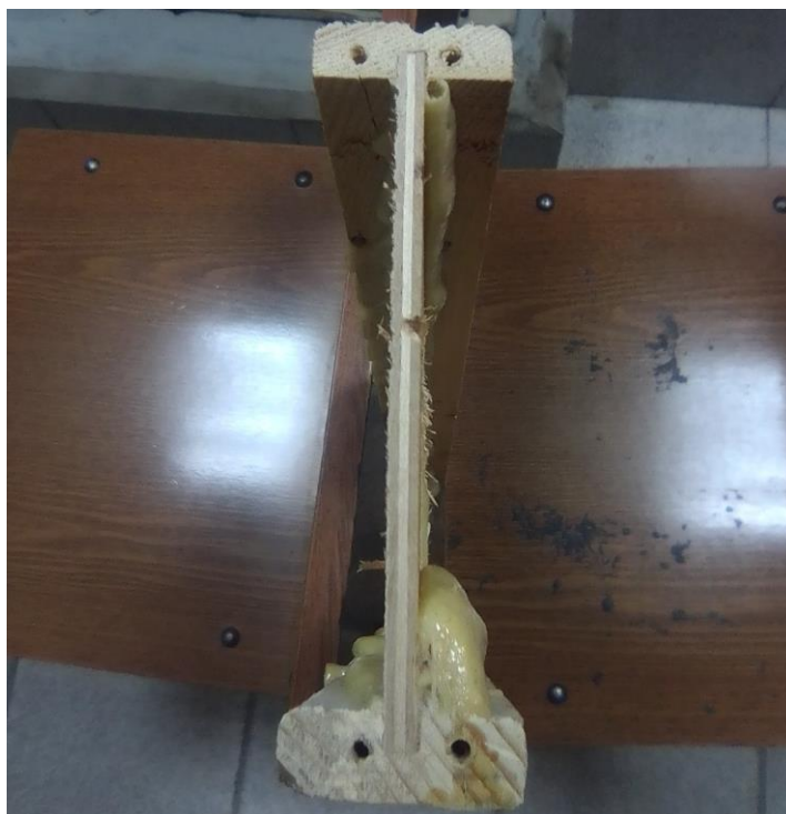
Рисунок 5. Поперечное сечение испытываемых балок (фото авторов)
