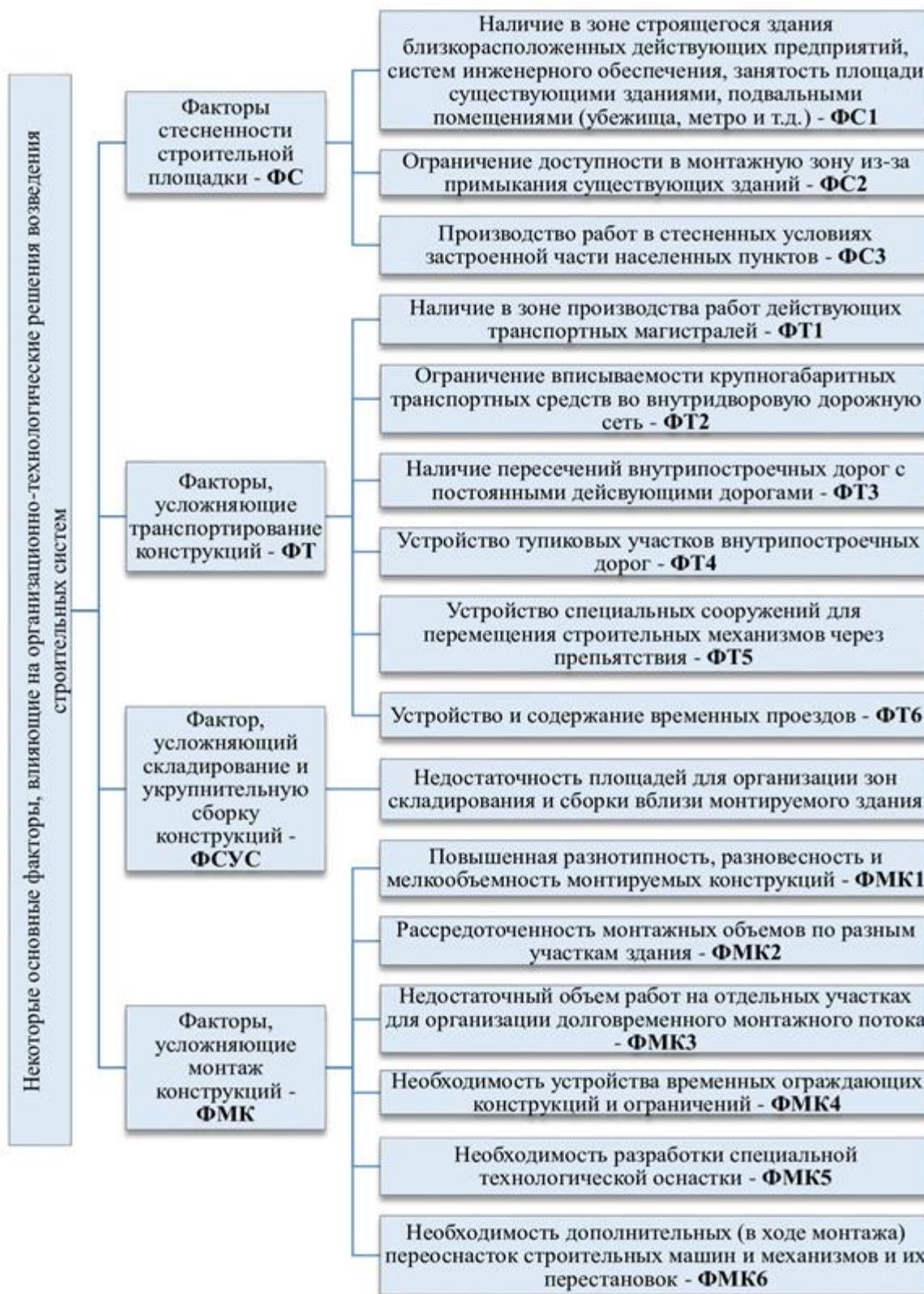
Рисунок 3. Некоторые основные факторы, влияющие на организационно-технологические решения возведения строительных систем (составлено авторами по данным [6])
