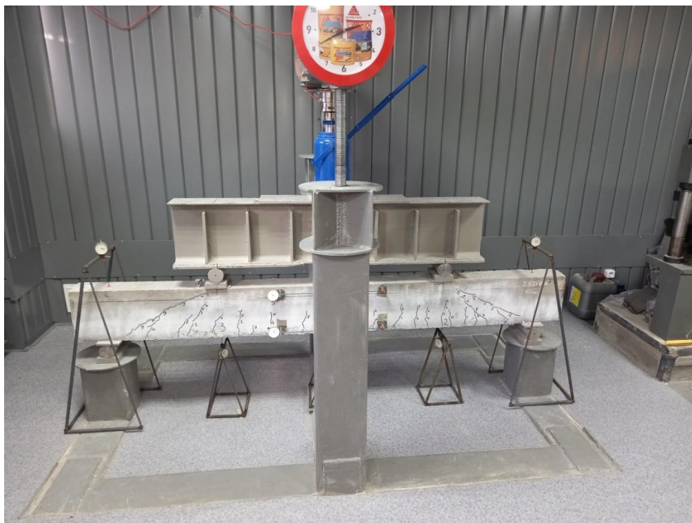
Рисунок 5. Общий вид металлической рамы, на которой производится испытание конструкций на четырехточечный изгиб и балки после испытания (фото авторов)
