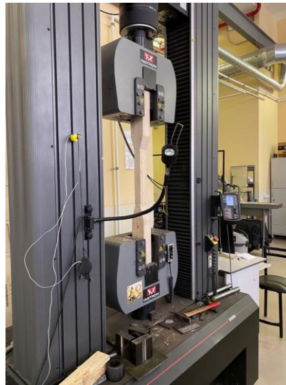
Рисунок 1. Кратковременные испытания образцов LVL на растяжение (предоставлено авторами)
