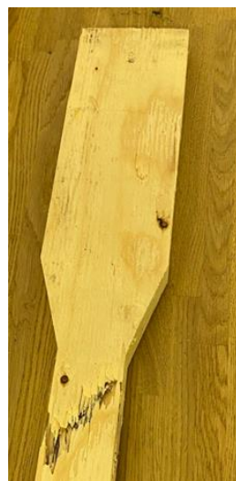
А) Разрушение образца с углом наклона волокон 0^\circ в рабочей зоне
