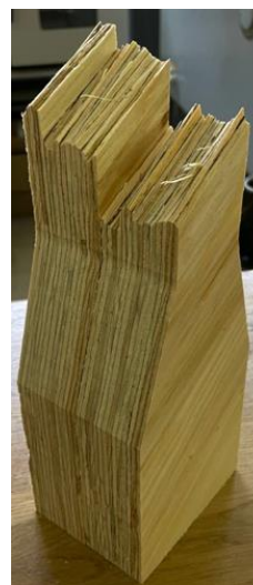
Б) Разрушение образца с углом наклона волокон 60^\circ в рабочей зоне
