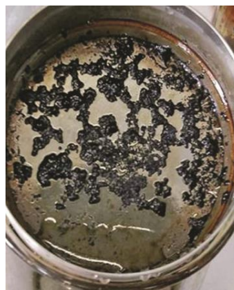
Рисунок 1. Осадкообразование при взаимодействии соляной кислоты 24 % масс и нефти при 80 °С [13]: а) Образовавшаяся неустойчивая эмульсия; б) Осадок после фильтрации эмульсии через сито 200 меш.
