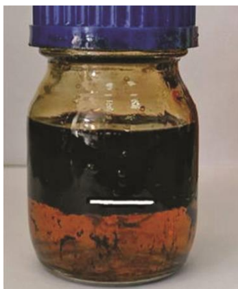
Рисунок 1. Осадкообразование при взаимодействии соляной кислоты 24 % масс и нефти при 80 °С [13]: а) Образовавшаяся неустойчивая эмульсия; б) Осадок после фильтрации эмульсии через сито 200 меш.
