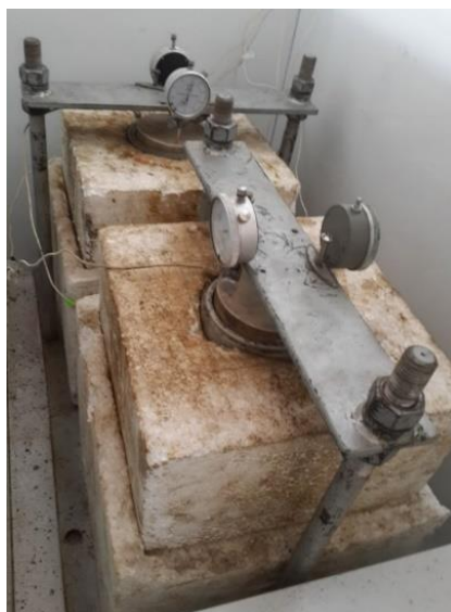
Рисунок 2. Лабораторная установка для испытаний на морозное пучение (составлено автором)
