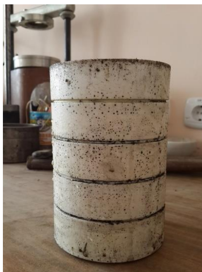
Рисунок 3. Испытанный образец грунта в кольцевой обойме после воздействия морозного пучения (составлено автором)
