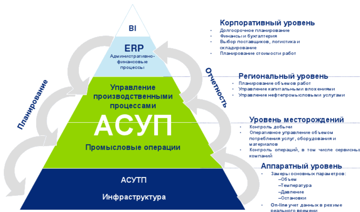
Рисунок 5. Технология «интеллектуального» нефтепромысла в структуре информационных потоков предприятия [7]
