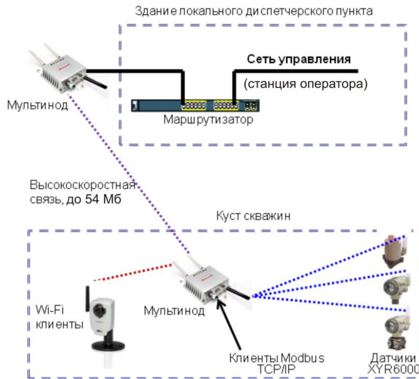
Рисунок 7. Беспроводные решения для кустов скважин [7]
