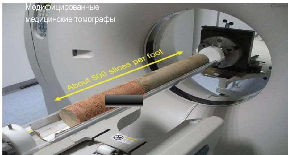
Рисунок 2. Рентгеновский томограф, для исследования полноразмерного керна [5]
