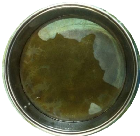
Рисунок 5. Результаты теста на совместимость нефти баженовской свиты с разработанным кислотным составом (составлено авторами)
