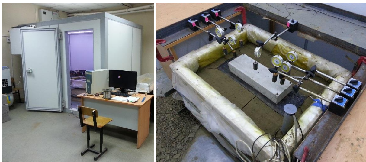
Рисунок 7. Общий вид экспериментальной установки, помещенной в морозильную камеру (составлено авторами)
