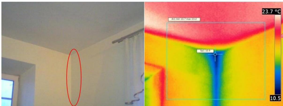
*Рисунок 3. Пониженная температура в углу помещения (разработано авторами)*
